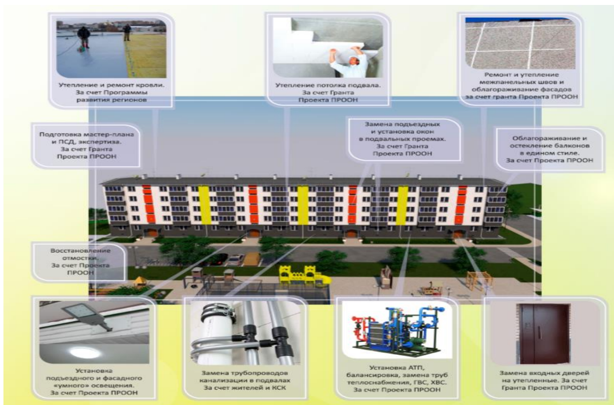
Рис. 5. Типовой набор энергоэффективных мероприятий для типового панельного жилого здания в Казахстане (по итогам реализации пилотного проекта в г. Нур-Султан)
