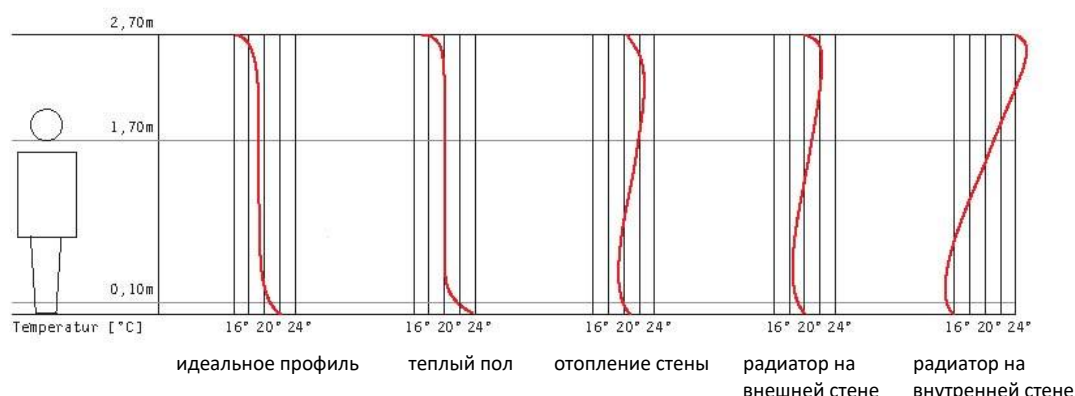
Рис. 13: Профили комнатной температуры воздуха систем теплопередачи 12
