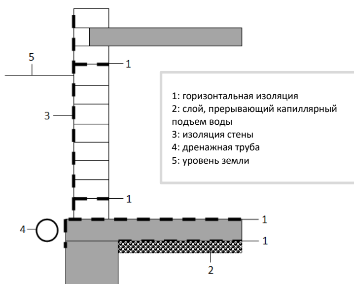
Рисунок 6: Изоляция подвала
