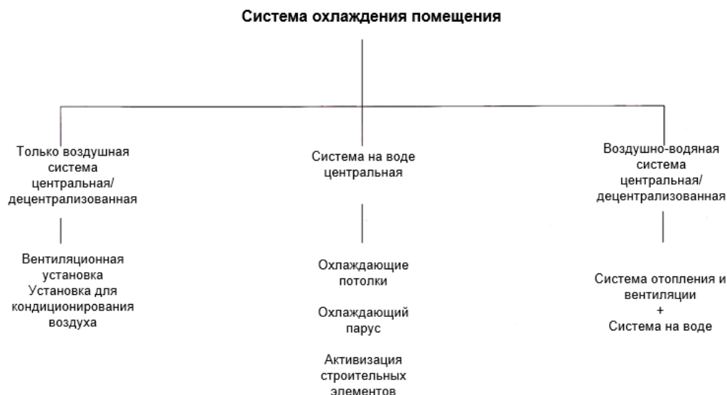
Рис. 8: Обзор систем охлаждения помещений (по Хайнер 2010, стр.62)
